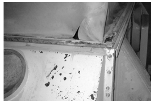
Fig. 5: fessura nell'involucro
