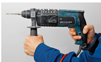
2 Trapano, classe di protezione 2
