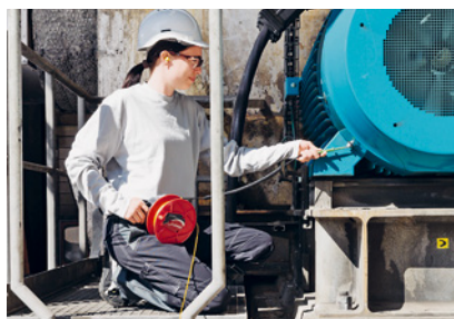
1 Verifica del conduttore di protezione
