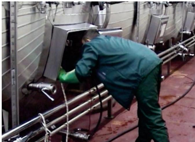
Un altro fattore che può determinare più o meno la complessità delle operazioni, sia di ispezione vera e propria che dell'eventuale recupero della persona, è l'orientamento dell'asse principale del recipiente: orizzontale o verticale per le autoclavi di fermentazione ed orizzontale per le presse pneumatiche.
